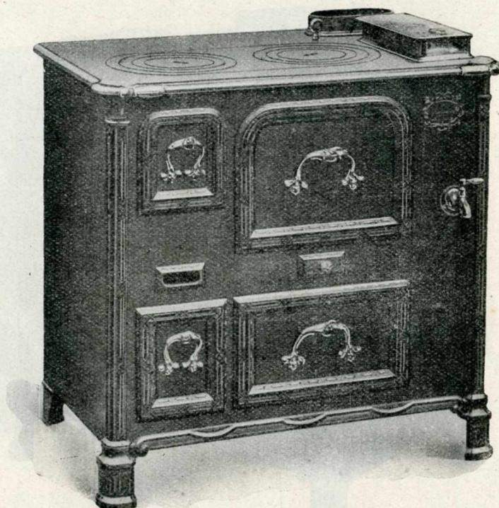
Ces fourneaux sont livrés avec dessus fonte ordinaire, façade tôle ordinaire avec barre et supports cuivre, poignées nickelées, porte abattante au four et ouvrante à l'étuve, buse mobile dessus ou derrière à volonté, porte abattante au foyer, à un four et une étuve.
